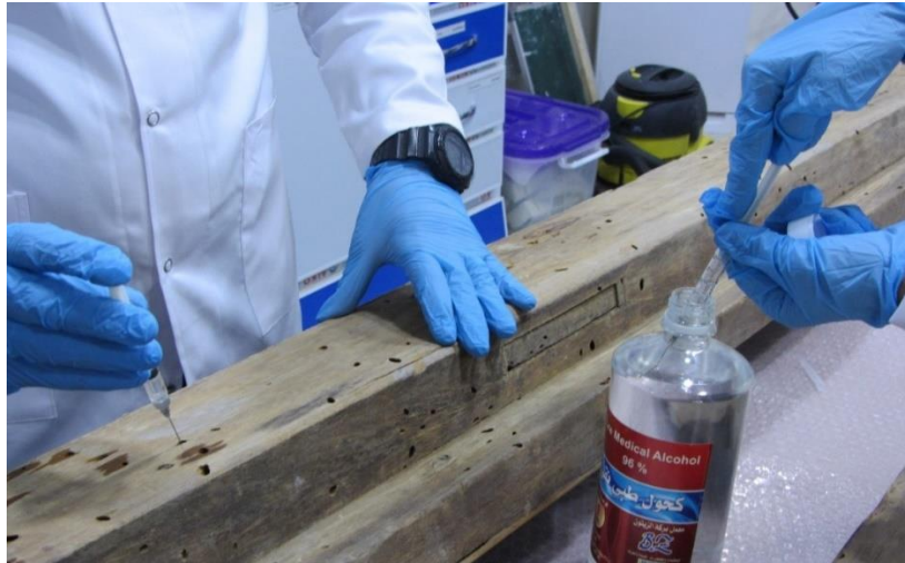
الصورة (١٧) توضح عملية تعقيم الباب الخشبي بمادة الكحول
