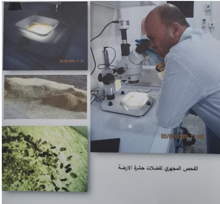
الصورة (١٠) توضح الفحص المجهرى لبودرة الخشب وملاحظة فضلات حشرة النمل الأبيض
