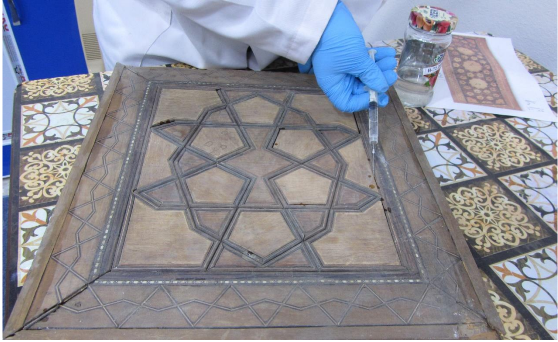
الصورة (٢١) توضح عملية تقوية الزخارف بواسطة البارالويد B-44 بطريقة الحقن
